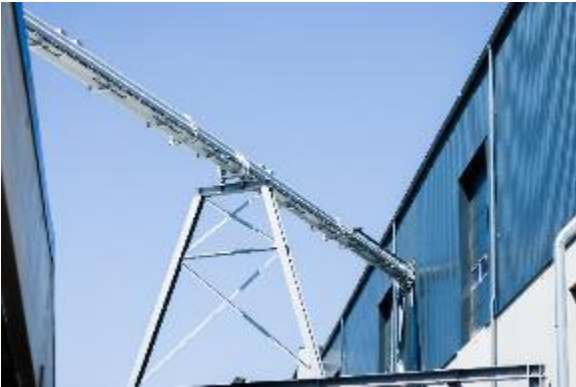
Bild 7: Der Vecobelt transportiert das Material quer über den Hof zu den Lagerboxen und der Siebstation und anschließend weiter zur Pelletverarbeitung.
