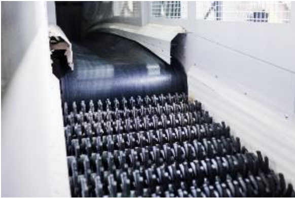
Bild 4: Das Sternsieb scheidet Überlängen aus dem Material ab.
