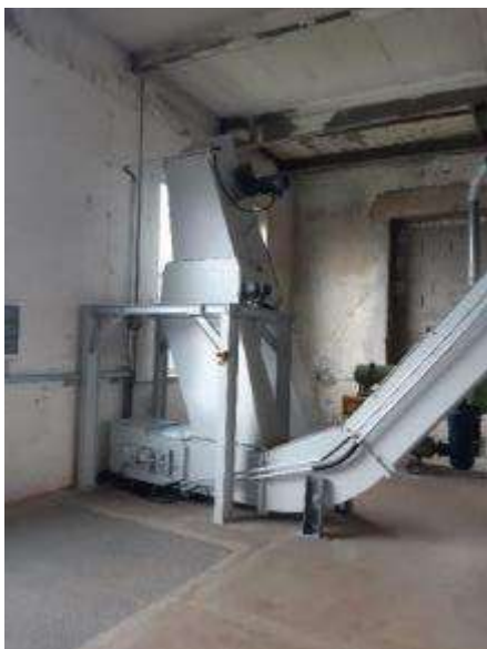
Bild 7: Auf der zweiten Etage wird die Masse von eisenhaltigen Metallen über die Magnettrommel entfernt.
