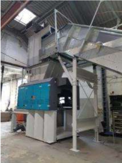
Bild 1: Der neue Zerkleinerer V-ECO 1300 von Vecoplan im Einsatz bei RKW: Zukünftig sollen Folienabfälle in ein homogenes Output-Material verwandelt werden.
