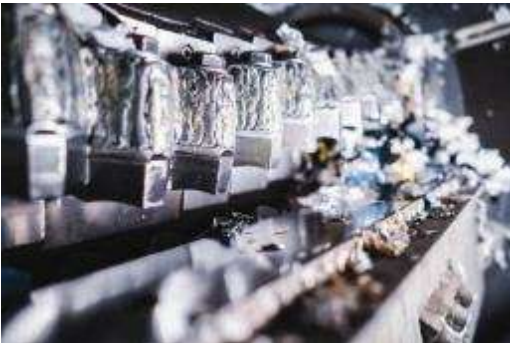
Bild 6: Über die Rotor- und Messer-Bestückung lässt sich die Anlage detailliert an die In- und Output-Anforderungen des Kunden individuell anpassen.
