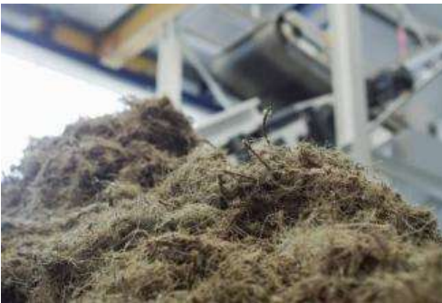
Bild 4: Über die Rotor- und Messer-Bestückung sowie die entsprechende Siebwahl lässt sich der Zerkleinerer detailliert an die Input- und Output-Anforderungen anpassen.
