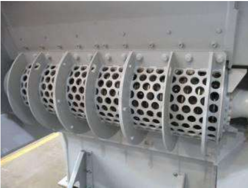
Bild 3: Das robuste Sieb kann für unterschiedliche Output-Korngrößen einfach gewechselt werden.
